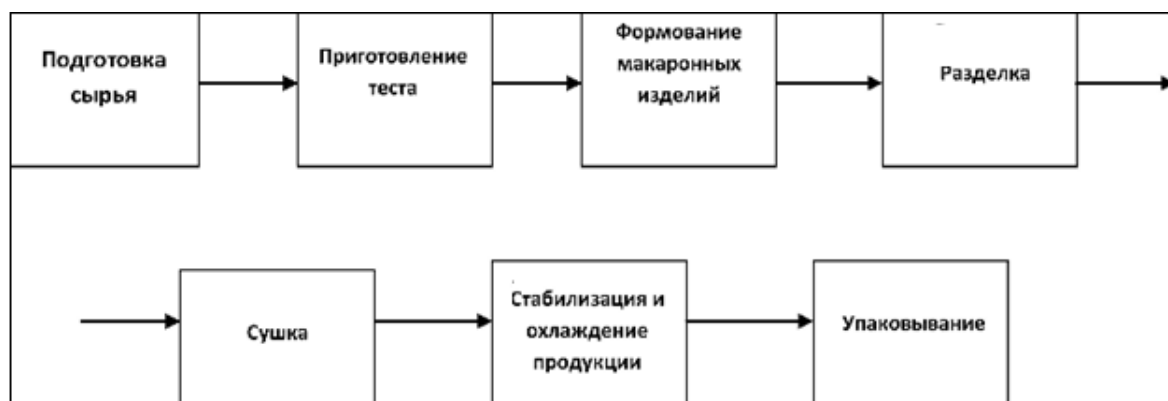
Рис. 1- Технологічна схема виробництва макаронних виробів
