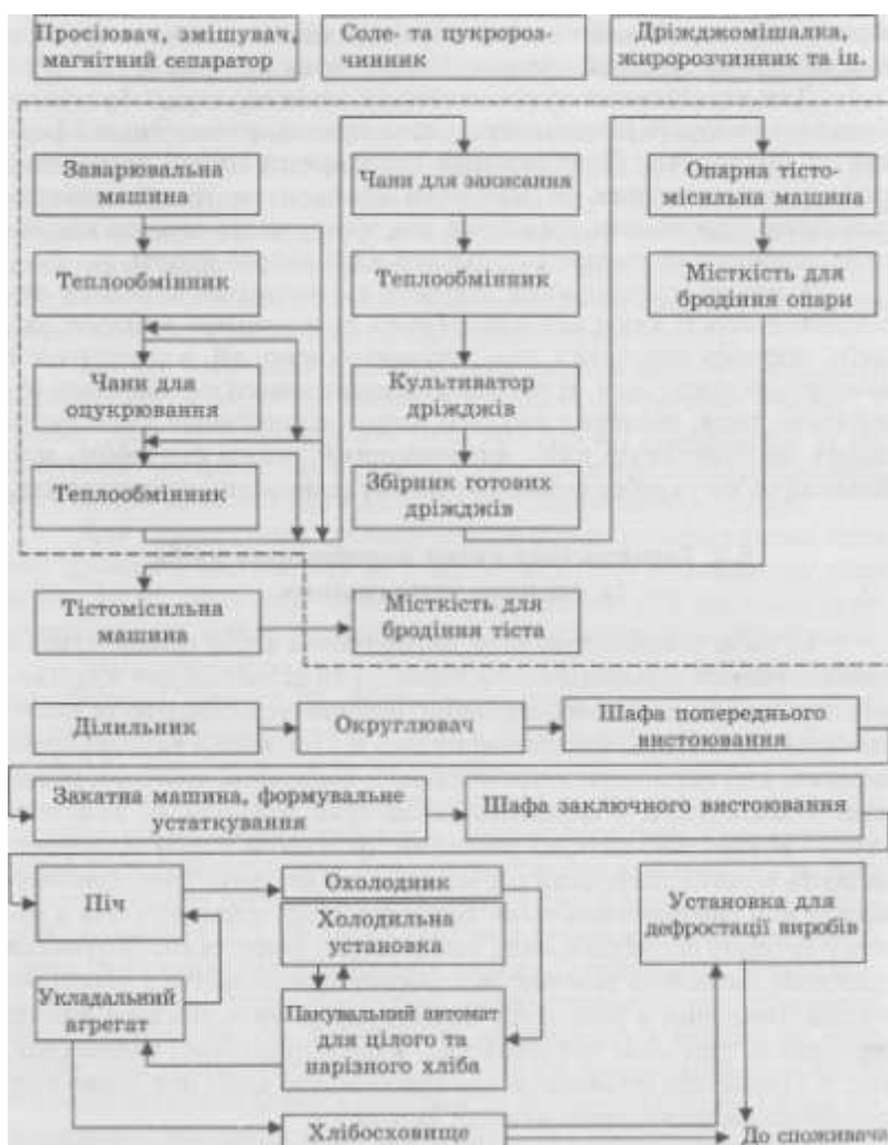
Структурна схема технологічного процесу виробництва хліба опарним способом на рідких дріжджах
