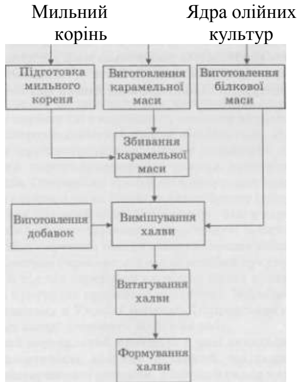
Рис. 9.5. Технологічна схема виготовлення халви
